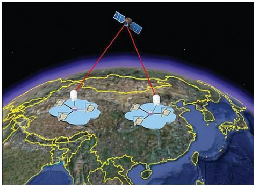
Figura 2. Representación del experimento del satélite Micius, enlazando dos redes cuánticas distantes protegidas por una clave criptográfica indescifrable. Fuente: Orbiter.Ch, “China’s quantum satellite clears major hurdle on way to ultrasecure communications”, 16 juin 2020, disponible en:
